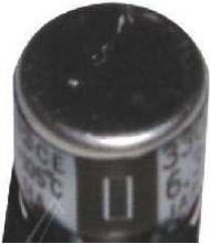
Kapacitás: 330uF, Feszültség: 96,3V, Elektrolit-kondenzátor, Dizájn: SMD, H: 105°C,
