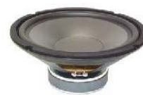
megerősített lemezkosár, konkáv lágyvas impregnált és merevített papír
