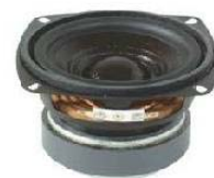
megerősített lemezkosár, konkáv lágyvas impregnált és merevített papír
